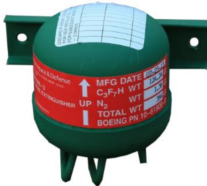
Figura 22: Extintor del baño del Boeing B737-NG [39].
