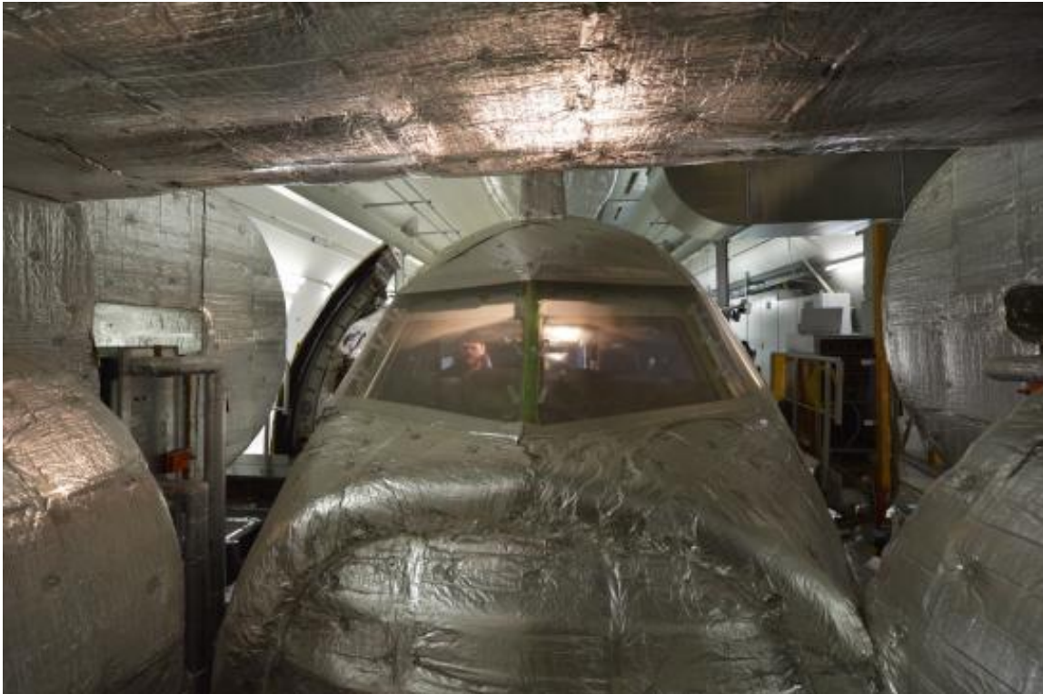
Figura 17: Fuselaje de aeronave para pruebas de extinción de incendios [20].
