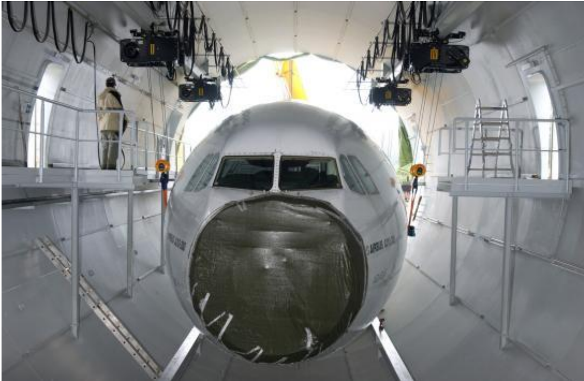
Figura 18: Fuselaje delantero de Airbus A310 para pruebas de presión [20].
