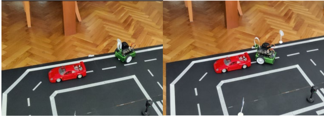
Figura 89 - Robot avanzando ante un obstáculo y parando cuando está apunto de colisionar
