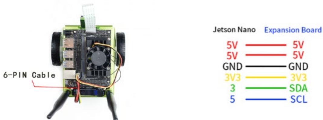
Figura 45 - Conexión entre placas [28]
