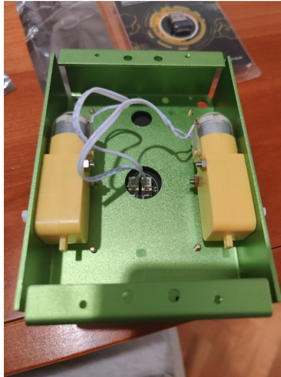
Figura 32 - Montaje de los motores
