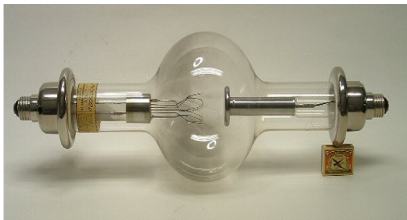
Figura. 2: tubo de rayos x de vidrio. 6
